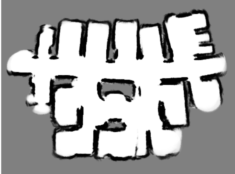
(a) Częściowa mapa lewej strony otoczenia wygenerowana na podstawie przekłamanych danych odometrycznych. Pomimo przekłamań oznaczanie lokacji i mapowanie topologiczne byłoby możliwe.
