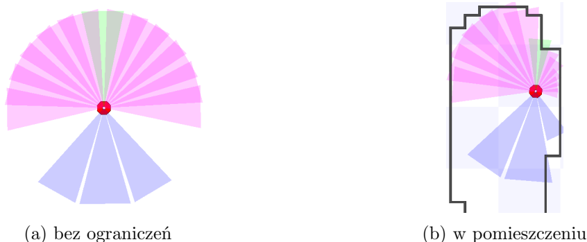
Rysunek 3.1: Rzut z góry obrazujący zakres sonarów na pierścieniu wokół robota. Zielona wiązka jest skierowana na wprost kierunku jazdy. Długość wiązek obrazuje przekazywaną przez sonar odległość od przeszkody lub, w przypadku jej braku, maksymalny zasięg sonaru. Zakresy sonarów w przedniej części nakładają się na siebie. Obrazek jest wycinkiem wizualizacji prezentowanej przez symulator Stage .
