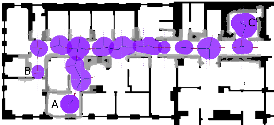
Rysunek 4.4: Obrazek przedstawia lokacje oznaczone podczas eksploracji z asystowanym maperem topologicznym. Robot poprowadzony został z punktu A przez punkt B do punktu C , w którym zakończył pracę. Obszary na trasie, które nie przynależą do żadnej lokacji to elementy korytarzy pominiętych dla zachowania czytelności. Obrazek powstał przez nałożenie na wyeksplorowany fragment planu rzutów ekranów z symulacji.
