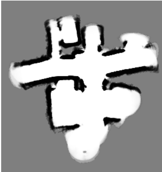
(b) Przykład błędu mapowania całkowicie uniemożliwiającego dalsze działanie. Po zbudowaniu lewej mapy robot udał się do pomieszczenia A , w którym utracił informację o swoim obrocie. Następnie robot przemierzył korytarz po raz drugi powodując fatalne przekłamanie mapy. Ciemnym kolorem oznaczona jest błędna trajektoria, przyjęta przez robota, a jasnym poprawna. Efektem jest złożenie się ze sobą dwóch kopii tej samej mapy, ale w różnych układach odniesienia.
